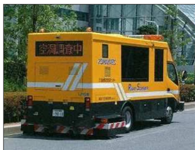
路面下空洞調査
