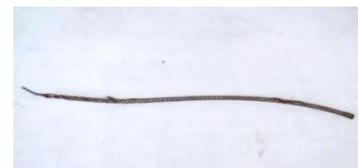
調査した事故ロープ破断部試料(左端が破断部)
