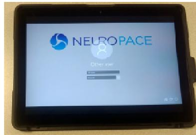
プログラミングの際には、プログラミング用のソフトウェアが搭載された医師用プログラマータブレットが使用される。本体に記録された脳波データ、検知・刺激時の脳波記録をワンドと患者用リモートモニタータブレットを通じて PDMS (Patient Data Management System) にアップロードした上で分析し、医師用プログラマータブレットにて異常脳波の検知条件や刺激条件の調整をプログラミングする(PDMS 上で検知・刺激プログラミング調整を設定し、医師用プログラマータブレット上で刺激データをダウンロードする運用も可能)。
