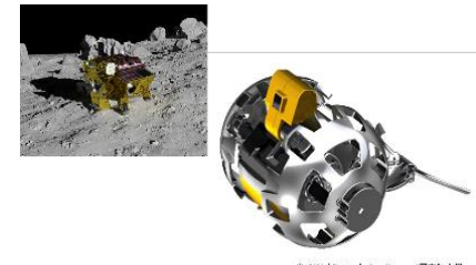
SLIMに搭載した変形型月面ロボット SORA-Q (宇宙探査イノベーションハブ研究の一例)
