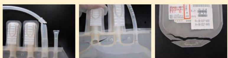
FFPバッグの破損事例
