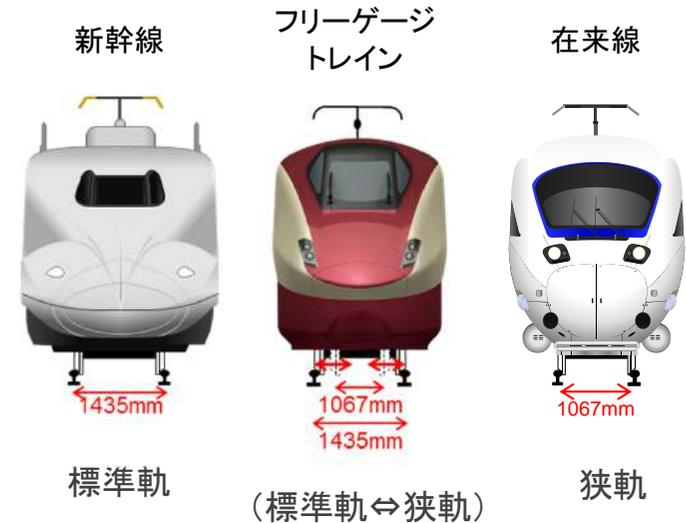
フリーゲージトレインは、車輪の幅を切り替えることにより、在来線用の幅が狭い線路（狭軌）と新幹線用の幅が広い線路（標準軌）の両方を運行することができ、新たに標準軌の線路を整備しなくて済むため、地元負担が少なくなることが期待されていた。
