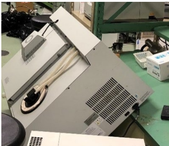
地震により遠心濃縮装置が故障
